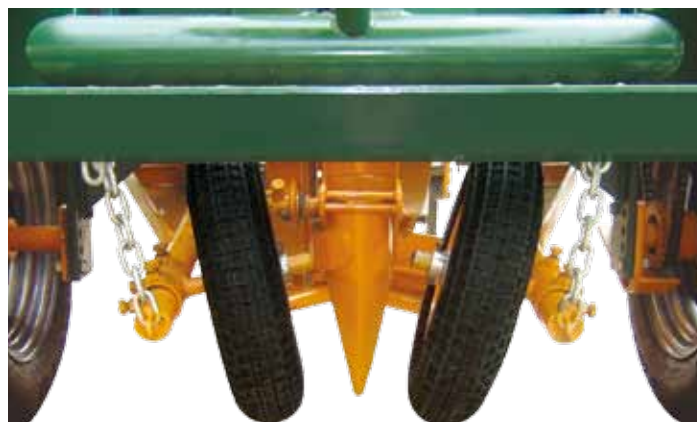
Conjunto mecânico concha, que deposita a muda na cova na profundidade correta, e rodas auxiliares que fecham o solo na pressão adequada, garantia de crescimento sadio da planta
